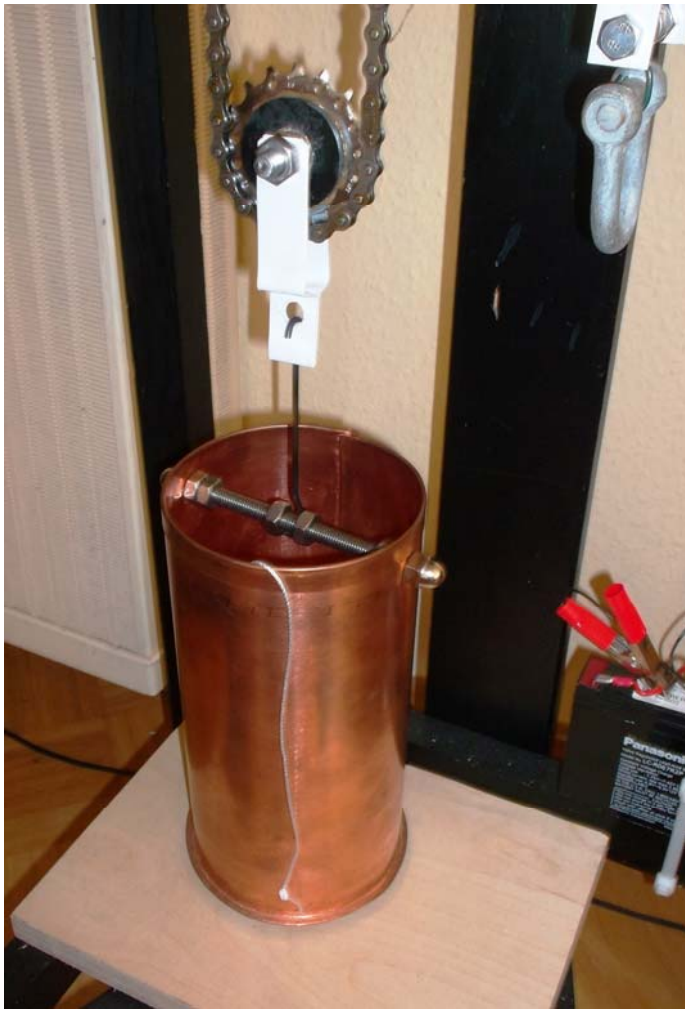
Bild 23: Links: Antriebsgewicht Füllung Bleischrot und 1kg- Bleigewichte (hier mit Faden) Rechts: kleines Gegengewicht zum Spannen der Kette
