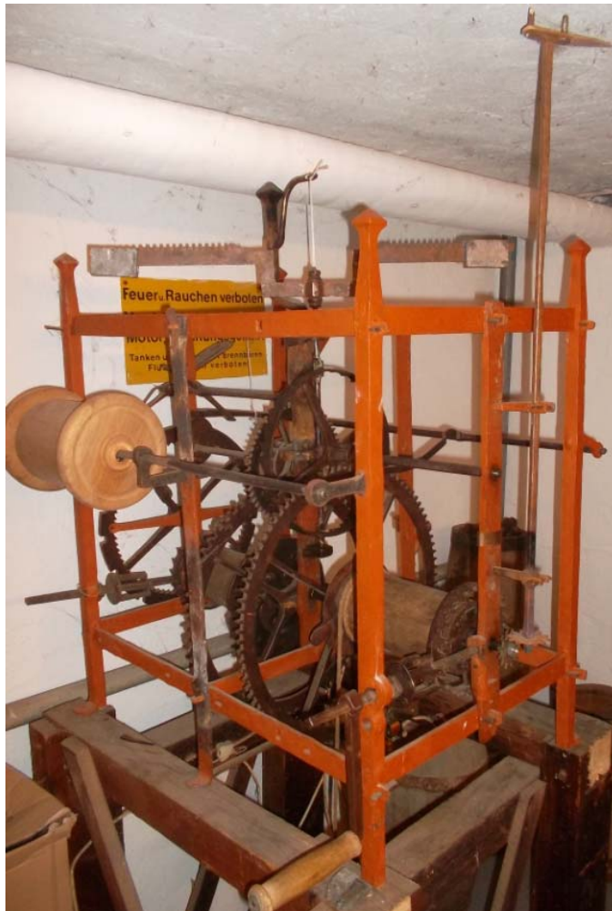
Bild 1: Turmuhr, datiert 1478 Überliefert als Spindeluhr (Pendel verloren). Rückgebaut vom Autor mit neuer Waag
