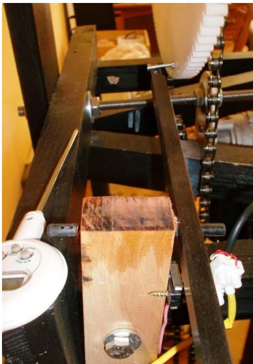
Bild 22: Mitnehmer auf Bodenrad, Heber zur Auslösung des Stundensignals Rechts vorn: Ein Prellkontakt löst beim Abfallen des Hebers das Stundensignal aus
