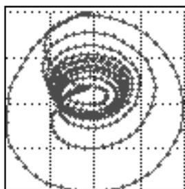
2. Fall: 1. Bifurkation (Im Zeitdiagramm sind abwechselnd zwei Amplituden feststellbar. Die Trajektorie läuft abwechselnd auf zwei verschiedenen Ellipsen.)
