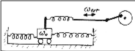
Der zwischen zwei Zugfedern eingespannte Wagen der Masse  $m$  wird von außen durch eine periodische Kraft  $F_{err}$  mit der Erregerfrequenz  $\omega_{err}$  zu erzwungenen Schwingungen angeregt. Das Verhalten des Schwingers hängt vom Verhältnis der Eigenfrequenz  $\omega_0$  zur Erregerfrequenz  $\omega_{err}$  ab. Dabei lassen sich drei Fälle von Grunderscheinungen beobachten.
