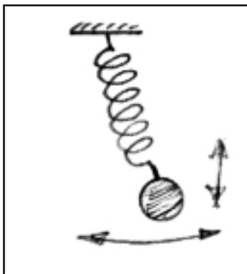
Den dritten Freiheitsgrad als notwendige Bedingung kann man statt durch eine äußere Anregung auch über zweidimensionale Schwingungen erhalten. Man hat dann zwei Weg-Freiheitsgrade und zwei Geschwindigkeits-Freiheitsgrade. Die Kopplung durch den Energiesatz reduziert diese auf drei Freiheitsgrade.
