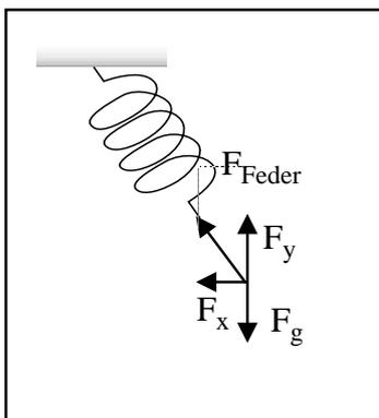
Dieses gekoppelte DGL-System kann man nur numerisch lösen, etwa mittels eines Modellbildungssystems. Die Ortskurven sind bei rationalem Periodenverhältnis in  $T_x/T_y$  in  $x$ - bzw. in  $y$ -Richtung wie beim Magnetpendel periodisch verschieden:
