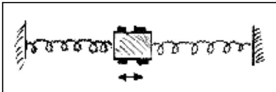
Auch die folgende Schwingung eines eingespannten Wagens zwischen zwei Zugfedern ist eine harmonische Schwingung ( $D^* = 2 \cdot D$ ). Unter Berücksichtigung der Reibung mit der Reibungskonstanten  $R$  ist die DGL:
