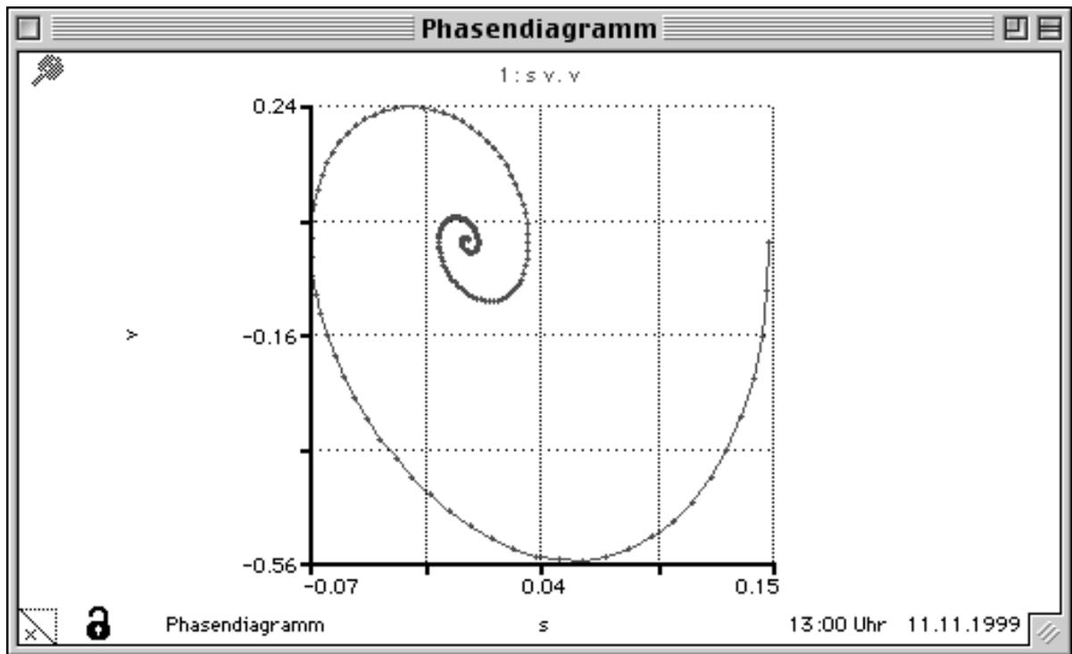
Analog zum **Gummipendel** kann das **Schiefe-Ebene-Pendel** behandelt werden. Dabei handelt es sich um eine doppelschiefe Ebene, auf der eine Kugel rollt. Als Ebene bieten sich Profilleisten aus dem Bauhandel an. Hier handelt es sich um eine nichtlineare Schwingung, da die rücktreibende Kraft immer konstant ist. Ähnlich wie beim Gummipendel kann die Dämpfungskonstante ermittelt werden.
