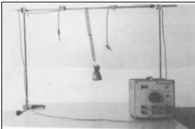
Das Feder-Faden-Pendel lässt sich auf Schulniveau sogar sehr gut durchrechnen und experimentell aufbauen und beobachten. Dazu befestigt man am Gewichtsstück eine Glühbirne, die man über sehr dünne Kupferdrähte mit der Spannungsquelle verbindet.
