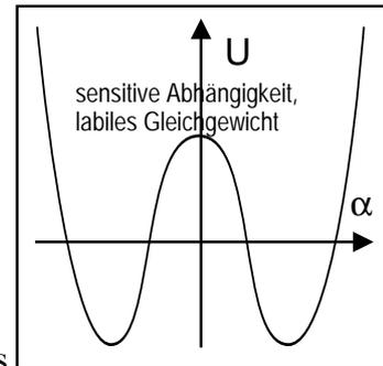
1. Es bedarf eines nichtlinearen Potentials mit W-Form. (Der Hintergrund ist der, dass durch die W-Form am Potenzialwall eine Stelle sensitiver Abhängigkeit, also eine labile Gleichgewichtsstelle vorhanden ist, wo das Pendel nach rechts oder nach links ausschlagen kann.)
