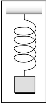
Für die rücktreibende Kraft gilt das lineare Kraftgesetz, sodass mit der newtonschen Grundgleichung die Differenzialgleichung folgt:
