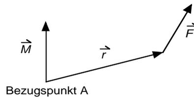
Drehmoment  $\vec{M} = \vec{r} \times \vec{F}$  mit  $\vec{M} \perp \vec{r}$  und  $\vec{M} \perp \vec{F}$
