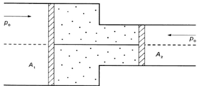
Bevor das Gas um die Temperaturdifferenz  $\Delta T$  erwärmt wird, sollen sich die Kolben im gleichen Abstand von der Verbindungsstelle der Zylinder befinden.
